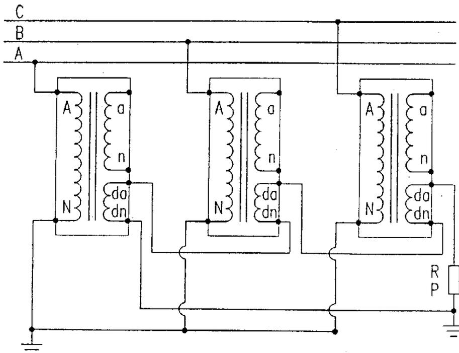
چنانچه ولتاژ نامی سیم‌پیچ ثانویه  $da-dn$ ،  $100/3$  ولت است مقاومتی برابر با  $11 \Omega$  بایستی برای این امر در نظر گرفته شود. برای ولتاژ ثانویه  $110/3$  ولت، مقدار مقاومت می‌بایست  $13.5$  اهم باشد. توان مقاومت مورد نیاز بستگی به ولتاژ نامی و زمان نامی (مدت زمان پیش‌بینی دوام اتصال زمین) دارد.
